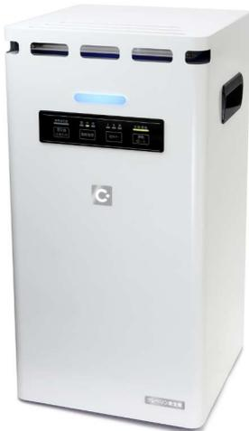
『クレベリン発生機 エレクローラー』は、本体にセットした「エレクローラー専用液 500mL」を電気分解して、低濃度の二酸化塩素ガスを空間中に放出させる装置です。二酸化塩素分子による特異的な作用で、ウイルス・菌・ニオイを除去します。初回導入時に専門技術スタッフが設置先に訪問し、ご使用空間に適した二酸化塩素ガス濃度になるように本体の設定を行います。そのため、小規模から中規模のオフィス・ロビー・待合室等の幅広い空間に対応することができます。設置工事不要で、ご使用時には通常の家電と同様、家庭用電源(AC100V)で稼働します。また、充実したタイマー機能で、使用環境に合わせ16パターンの設定ができます。専門技術スタッフが、定期訪問メンテナンス(月1回)に伺い、専用液の交換を行います。詳細は、大幸薬品 感染管理事業部 機械営業グループ (TEL: 03-5425-1141, E-mail: corp\_info@seirogan.co.jp)にて承ります。
